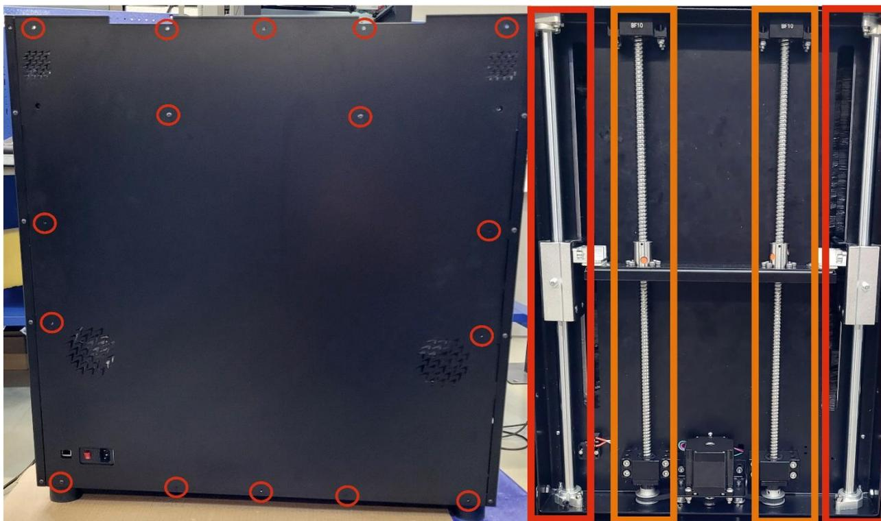
4. Сухой ветошью полностью очистить от грязи винты ШВП и цилиндрические направляющие:
