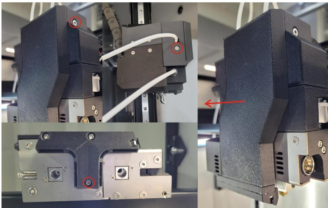
С помощью пылесоса следует очистить от пыли сопла для выхода воздуха на печатающей головке, а также продуть воздуховоды на снятой крышке печатающей головки. Очищать воздуховоды на крышке допускается сжатым воздухом (с помощью баллона или компрессора).
