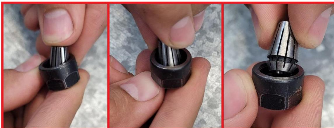
При установке новой цанги следует убедиться, что цанга защёлкнулась в гайку, и только после этого устанавливать цангу с гайкой в патрон:
