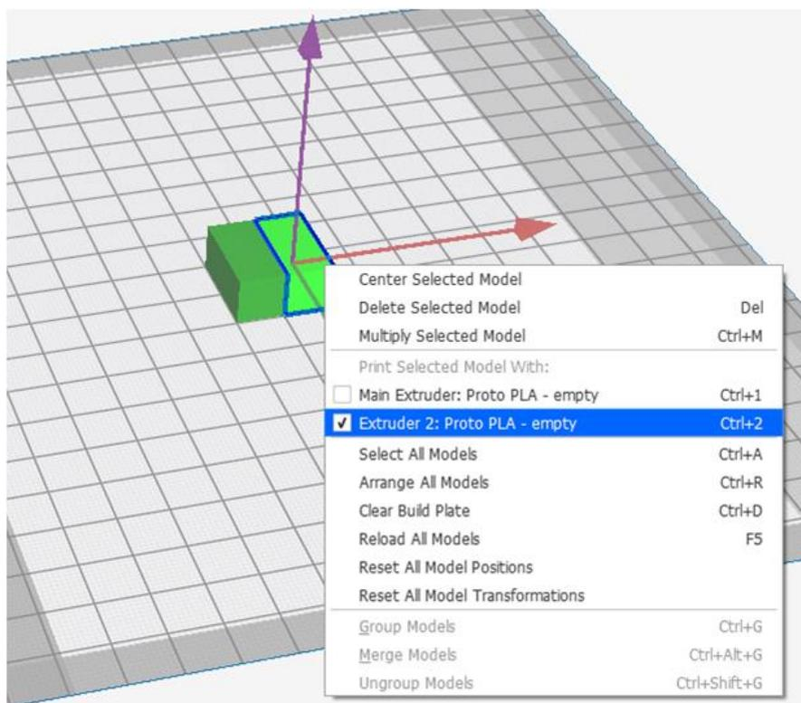
5. Напечатать деталь с данными настройками. Результат должен быть таким, как на картинке ниже: два бруска из PLA-пластика одного и другого цвета надёжно скреплены и образуют единую модель. Если получен неудовлетворительный результат – следует откалибровать положение экструдеров XY, как описано в подразделе 4.3.12.
