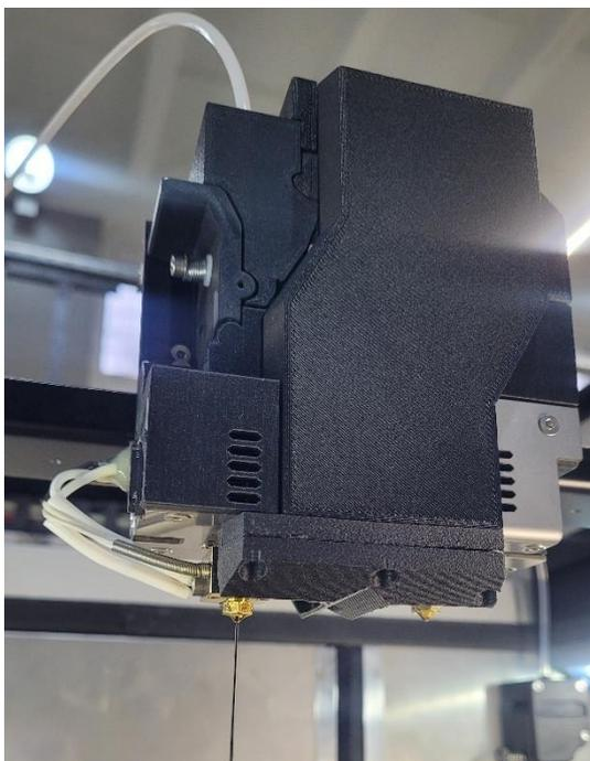
Для вспомогательного (правого) экструдера прижим регулируется аналогично. Двигатель подачи и регулирующий винт правого экструдера находятся на задней стенке принтера в правом верхнем углу камеры.
