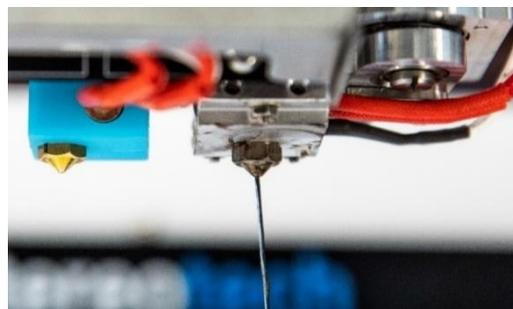
Если какое-то из данных условий не соблюдается – следует выкрутить сопло и оценить состояние фторопластового вкладыша. Оценка и замена вкладыша описана в подразделе 4.3.9.
