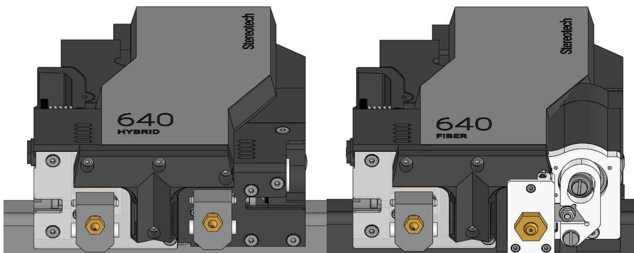
Основной (левый) экструдер принтеров Hybrid и Fiber адаптирован под работу с филаментами диаметром 1,75 мм. Тип экструдера – прямой (Direct), двигатель и механизм подачи установлены внутри печатающей головки.
