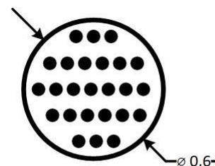
В технологии Fused Filament Fabrication для печати с армированием чаще всего используют углеволокно, стекловолокно и кевларовое волокно – каждый материал имеет свои физико-механические свойства и служит для упрочнения изделий под определённые нагрузки. Например, наиболее распространённое углеволокно имеет очень высокую прочность при растяжении (около 1900 МПа).
