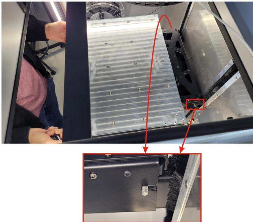
Затем вкрутить до упора 4 винта в верхнюю пластину крепления платформы и закрутить 2 гайки на боковых винта:
