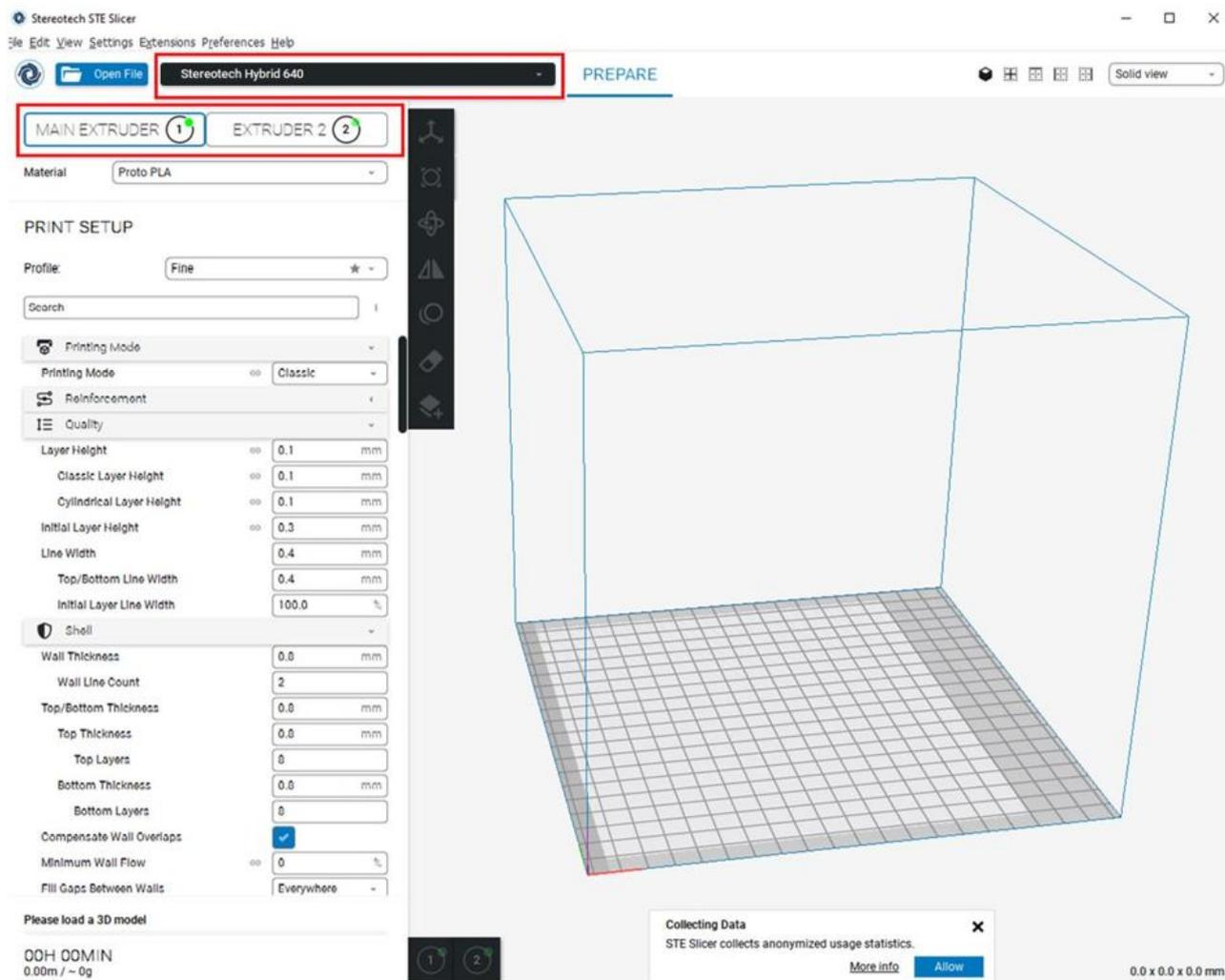
2. Убедиться, что установлен верный профиль материала: Proto PLA. Каждый экструдер настраивается отдельно, как показано на рисунке. Вкладки Режим печати (Printing Mode), Качество (Quality) общие для обоих экструдеров. Важные параметры для двухэкструдерной печати, которые необходимо добавить: Температура ожидания (Standby Temperature) и Ретракт при переключении сопел (Nozzle Switch Retraction Distance). Также выставить Обдув (Cooling) для каждого экструдера на 100% (для PLA).
