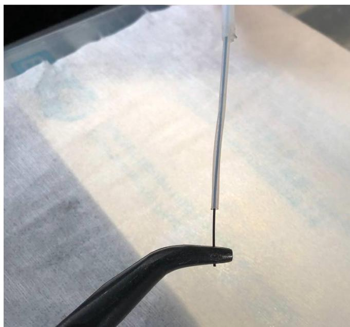
вперёд, в трубке не должно быть обломанных фрагментов. Если свободный конец волокна можно вытянуть из трубки – следует вытянуть обломок с помощью пинцета или плоскогубцев и подать необломанный филамент, после чего вставить трубку в экструдер.
