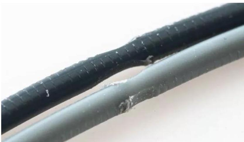
В обоих случаях следует выгрузить материал, отрезать деформированную часть филамента и загрузить его заново, отрегулировав прижим с нуля.
