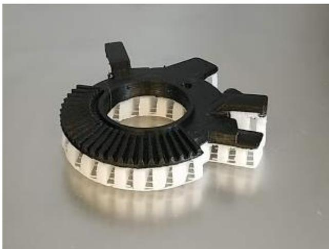
6. Также можно настроить печать поддержек основным материалом (ABS), а из дополнительного (SBS) печатать только связующий слой между поддержками и деталью (Support Interface). Настройки и визуализация приведены на рисунке ниже.
