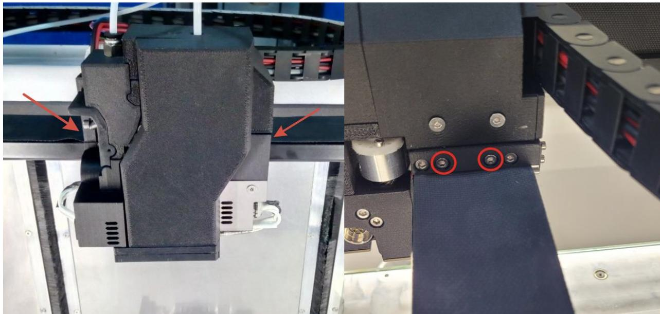
Также открутить 2 винта концевого выключателя оси X на задней части печатающей головки (концевик должен повиснуть на проводах):
