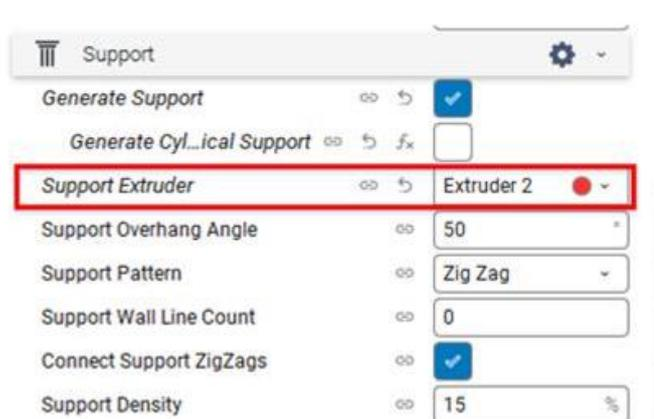
3. Второй экструдер аналогично настроить под материал поддержек – SBS. Здесь также важно установить настройки температур и ретрактов для второго материала. Остальные настройки печати по обоим экструдерам опциональны и зависят от детали.
