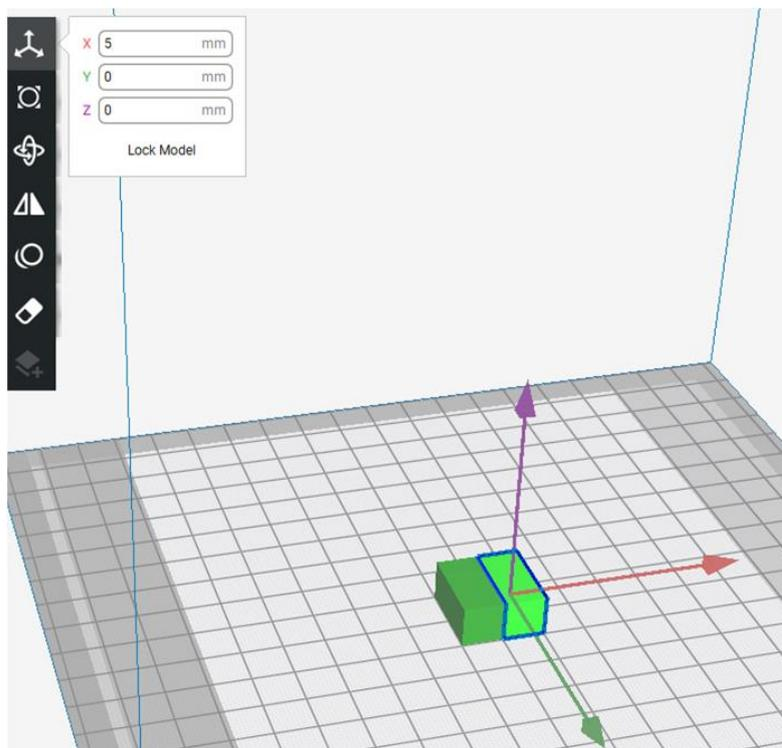
4. Кликнуть ПКМ по правому бруску, назначить для него Extruder 2. Цвет модели изменится: брусок для активного экструдера подсвечен, для второго экструдера – затемнён. Если назначить для экструдеров разные материалы, они будут помечены каждый своим цветом.
