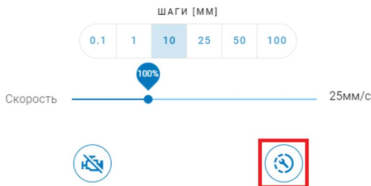
Затем включить нагрев основного экструдера. Следует выбрать целевую температуру, соответствующую температуре печати материала, для которого требуется отрегулировать прижим.
