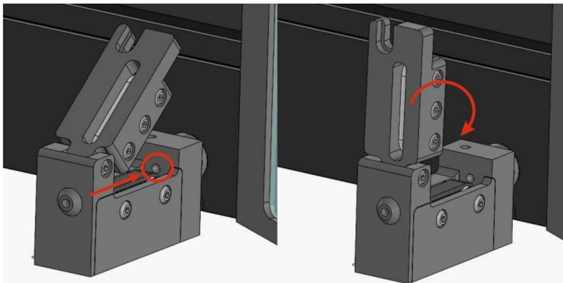
Когда волокно будет заправлено в податчик, следует подать волокно по всей длине трубки до печатающей головки. Если волокно не движется по трубке или движется с остановками – нужно сильнее закрутить прижимной винт на податчике, пока волокно не начнёт двигаться плавно. Если волокно не движется по трубке и двигатель подачи «заикается», пропуская шаги – нужно ослабить прижимной винт на податчике, пока волокно не начнёт двигаться плавно.
