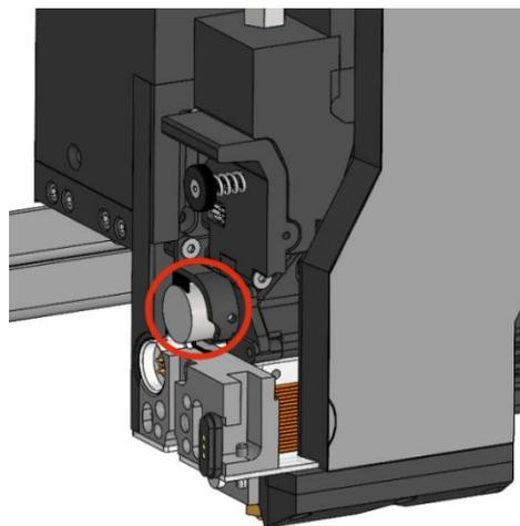
При обнаружении проблемы с наличием или подачей филамента принтер автоматически перейдёт в режим паузы и уведомит об ошибке либо запустит алгоритм автоматической прочистки (в зависимости от выбранного режима работы энкодера). После решения возникшей проблемы можно снять принтер с паузы и продолжить печать.
