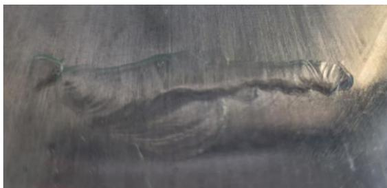
Также допускается при подготовке управляющей программы в слайсере сдвинуть модель по осям XY, чтобы печатать изделие на неповреждённой поверхности стекла:
