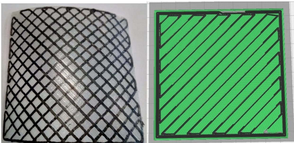
Плотность укладки волокна, тип рисунка и направление линий, соотношение волокна и пластика – эти параметры армирования задаются при настройке режима печати в ПО STE Slicer.
