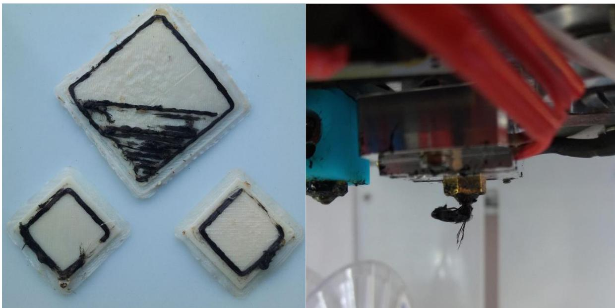
Диагностика: вручную разогреть экструдер до 270 °С, подать в экструдер 25 мм. Если из сопла появляются скомканные обрывки волокна, как на картинке выше – проблема в забитом сопле.
