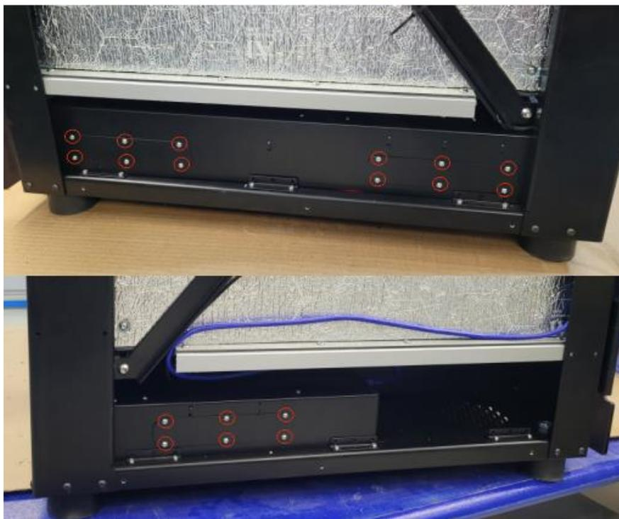
3. Через прорези очистить вентиляторы и внутреннее пространство модулей электрики и питания с помощью пылесоса, сжатый воздух не использовать:
