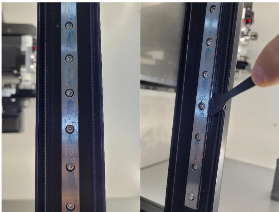
9. Смазать два продольных рельса (ось Y) и распределить смазку таким же образом, как описано в п. 7 .. 8.
