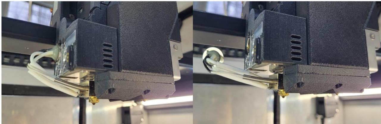
Ослабить винт, расположенный на печатающей головке слева, со стороны жгута, и фиксирующий принтблок:
