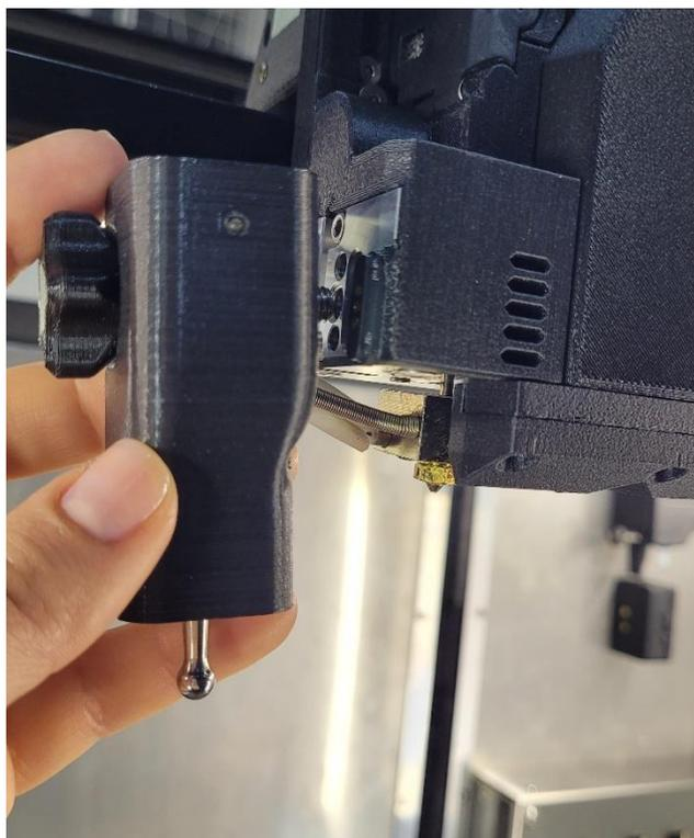
Чтобы сообщить программному обеспечению принтера о корректной работе датчика калибровки, по требованию менеджера следует нажать на зонд датчика снизу вверх. После установки датчика и получения сигнала от него начинается процесс автокалибровки.
