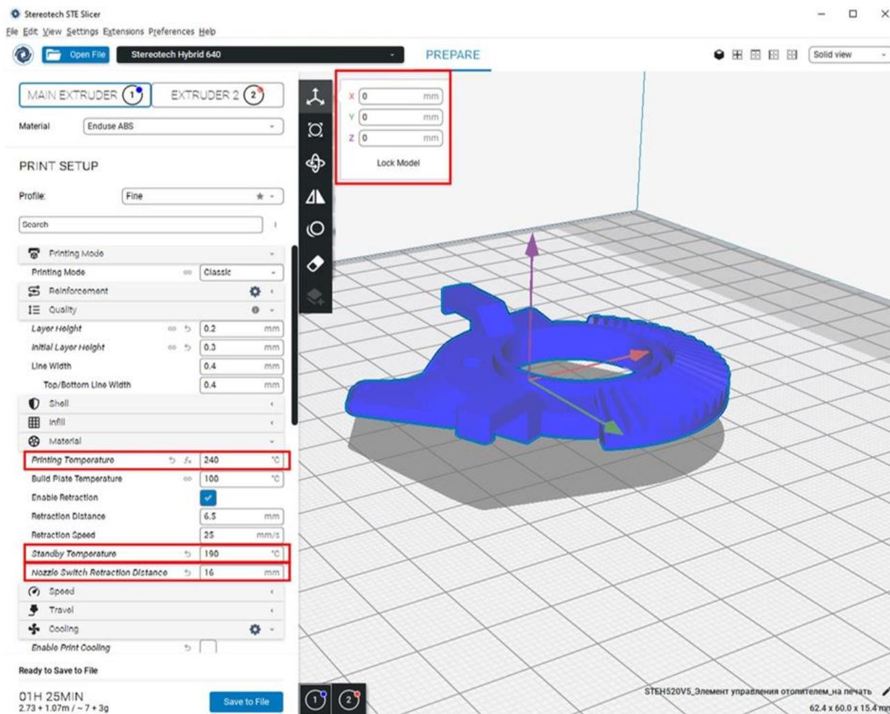
2. Затем настроить поддержки. Делается это также во вкладке первого экструдера. Главное – назначить Экструдер для печати поддержек (Support Extruder) как Extruder 2.
