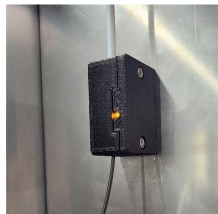
Энкодер, расположенный в печатающей головке, отслеживает равномерную подачу филамента с катушки в тефлоновую трубку и может сигнализировать о следующих проблемах:
