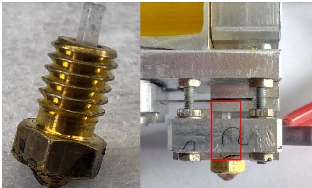
Сопло до упора закручивается в нагревательный блок и поджимается пальцевым усилием с помощью комплектного ключа или плоскогубцев.
