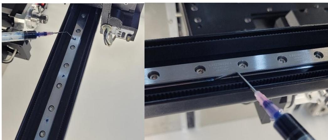
8. Для распределения смазки по рельсовой направляющей 8 раз вручную переместить печатающую головку по оси X влево-вправо. Смазка должна быть распределена тонким слоем. При необходимости вручную распределить смазку наконечником шприца, сухой чистой лопаткой для термопасты или аналогичным инструментом:
