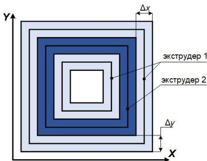
Чтобы открыть параметры профиля принтера, следует в STE Slicer выбрать опцию «Управление принтерами», выбрать нужный профиль принтера и открыть окно «Параметры принтера» соответствующей кнопкой. Чтобы скорректировать смещение второго экструдера, необходимо перейти на вкладку «Экструдер 2» и внести измеренные значения в поля «Смещение сопла по оси X/Y» следующим образом:
