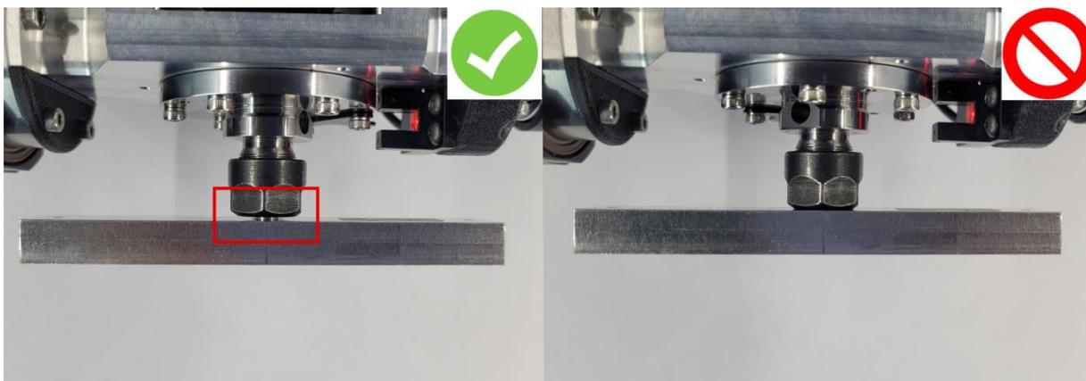
После установки калибровочного шаблона по запросу менеджера следует подключить датчик автокалибровки. Датчик устанавливается на левый бок печатающей головки, подключаясь контактом к специальному разъёму, и поджимается пальцевым усилием.
