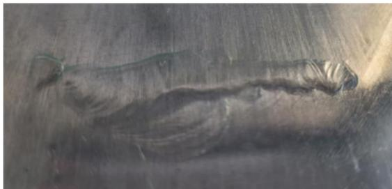
Также допускается при подготовке управляющей программы в слайсере сдвинуть модель по осям XY, чтобы печатать изделие на неповреждённой поверхности стекла:
