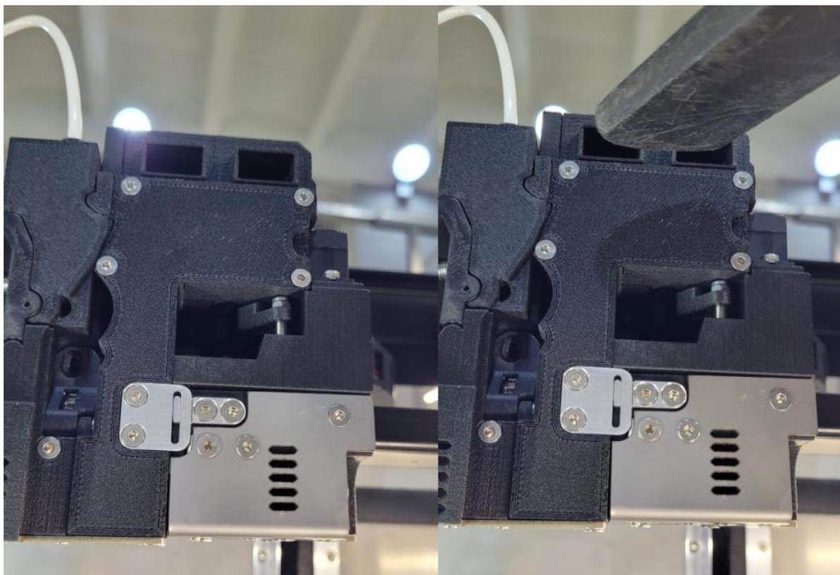
После очистки воздуховодов на печатающей головке и крышке следует установить крышку обратно и затянуть три фиксирующих винта.
