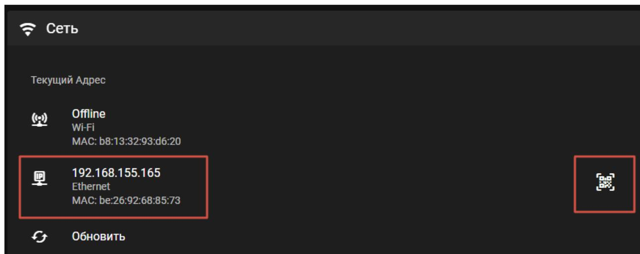
Также для подключения к web-интерфейсу принтера с ПК под управлением ОС Windows можно воспользоваться утилитой Bonjour Browser. После установки утилиты на ПК подключиться к принтеру через браузер можно по адресу: <http://st-abc.local> (где **abc** – ID принтера, указанный на фронтальной панели или в левом верхнем углу экрана).
