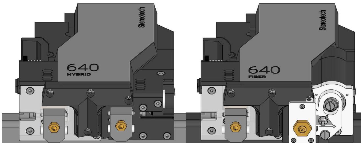
Основной (левый) экструдер принтеров Hybrid и Fiber адаптирован под работу с филаментами диаметром 1,75 мм, включая гибкие филаменты из серии материалов Sealant и ломкие филаменты с металлическим порошком для производства заготовок под запекание по MIM-технологии (например, BASF Ultrafuse 316L). Сведения о материалах для печати приведены в подразделе 3.5.5. Тип экструдера – прямой (Direct), двигатель и механизм подачи установлены внутри печатающей головки.
