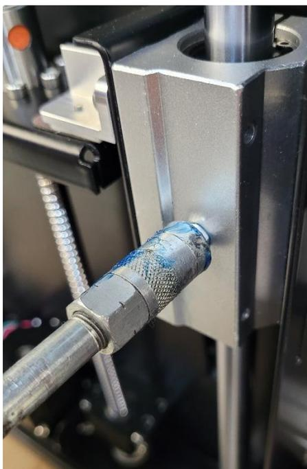
7. Для смазывания обоих винтов и направляющих потребуется в общей сложности около 5 мл смазки. После добавления смазки, не устанавливая обратно заднюю стенку, следует подключить принтер к сети и включить его, запарковать ось Z и 2 раза переместить 5D модуль / платформу вверх-вниз для распределения смазки (от верхнего положения Z0 до домашнего положения). Убедиться, что смазка распределилась по винтам и направляющим, в противном случае ещё 2 раза переместить 5D модуль / платформу вверх-вниз.
