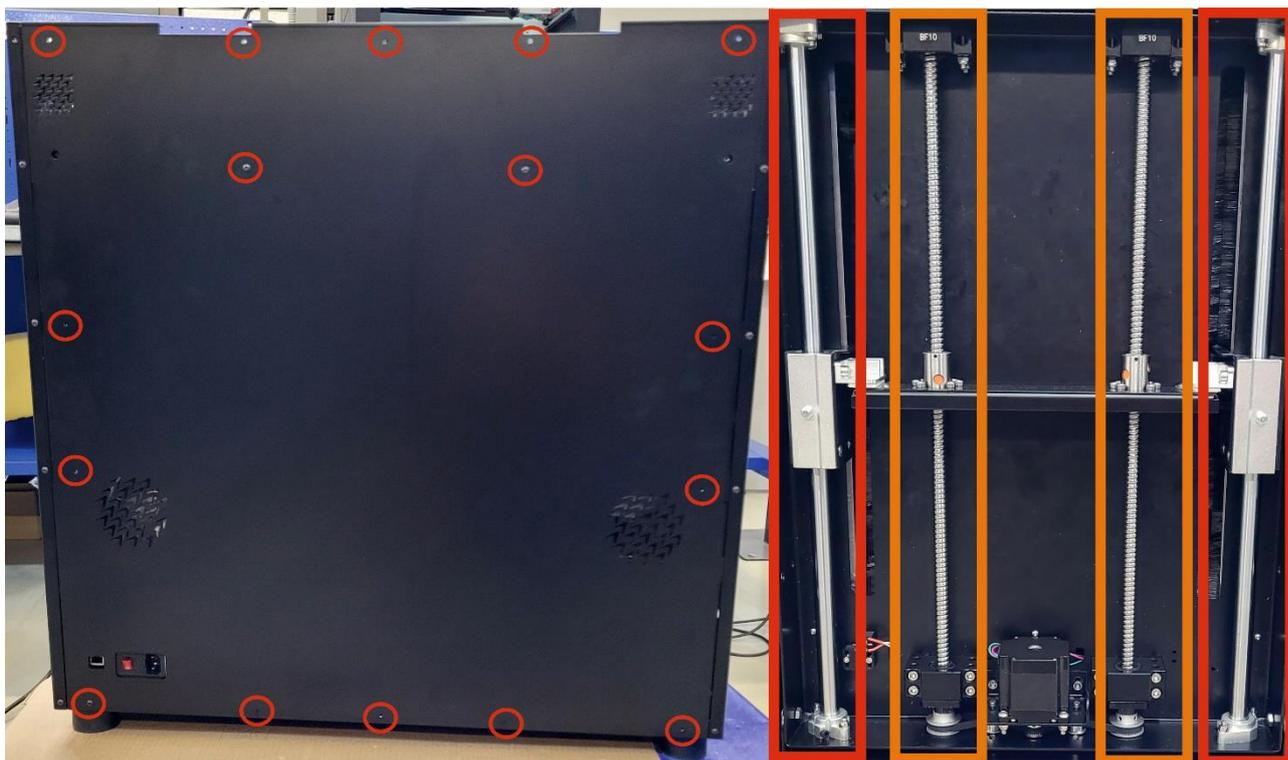
4. Сухой ветошью полностью очистить от грязи винты ШВП и цилиндрические направляющие:
