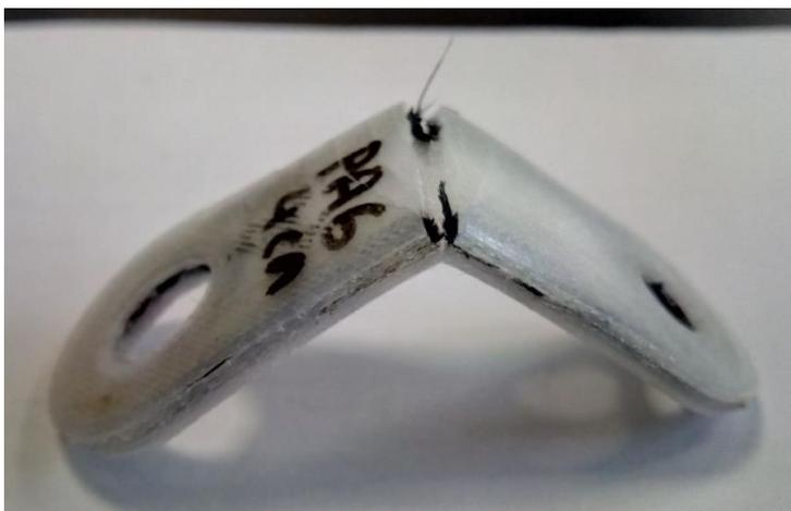
Как аналог PA6 для печати с армированием можно использовать пластик ABS/PA6 – менее гибкий и износостойкий, но более простой в работе и менее склонный к набору влаги.
