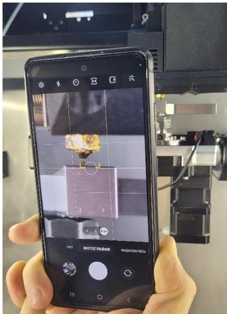
После совмещения сопла с шаблоном и установочным винтом автокалибровка завершена. По соответствующему приглашению следует снять шаблон и перейти к настройке точки старта печати согласно подразделу 3.4.10. Если точка старта настраивается непосредственно после автокалибровки, датчик допускается не снимать с печатающей головки.
