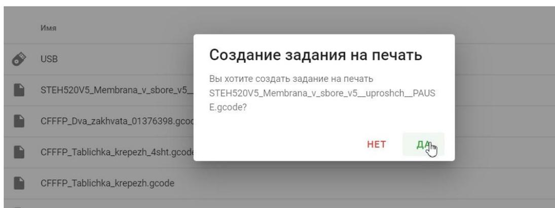
Задание создано и отобразится в очереди печати на главной вкладке **STE App – Печать**. Чтобы запустить печать задания из очереди, следует перевести принтер из состояния **Обслуживания** в состояние **Ожидания**:
