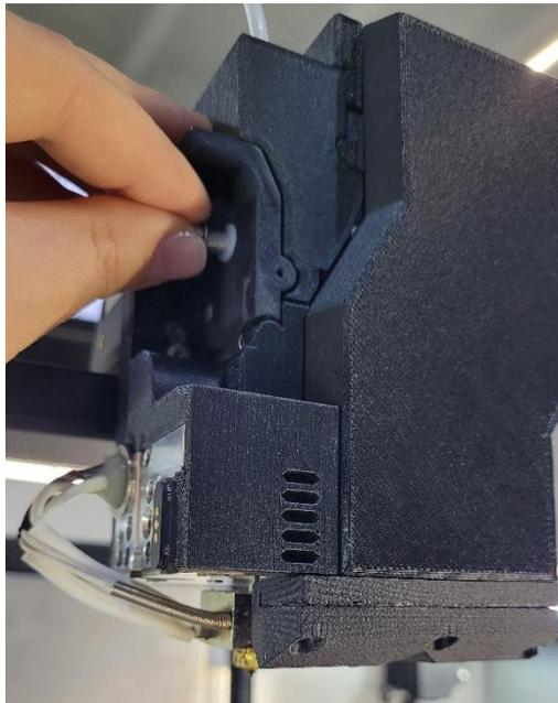
Через каждые пол-оборота винта подавать материал через сопло. Достаточный прижим обеспечен, если материал подаётся равномерно, нить на выходе – ровная и соответствует по толщине соплу установленного принтблока (по умолчанию устанавливается сопло диаметром 0,4 мм).
