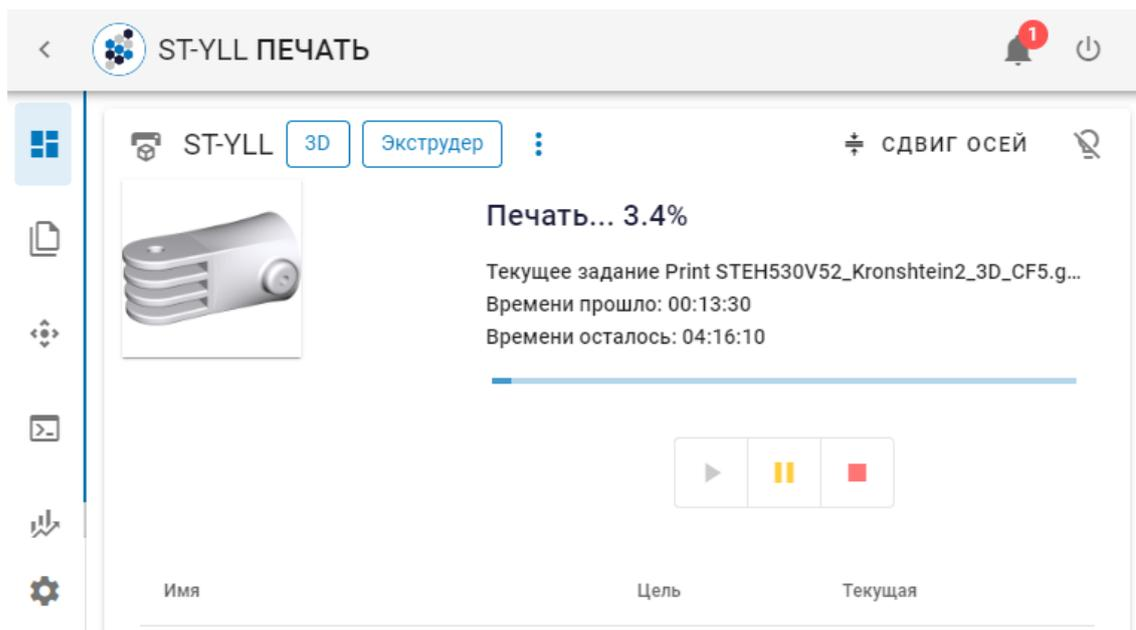
При нажатии на неё откроется панель управления, на которой можно выбрать ось и совершить передвижение по ней на заданный шаг. Например, если на первом слое печати зазор между соплом и поверхностью печати слишком большой, нужно выбрать ось Z, шаг 0,1 мм и нажать на кнопку «Вверх» (может понадобиться несколько нажатий).
