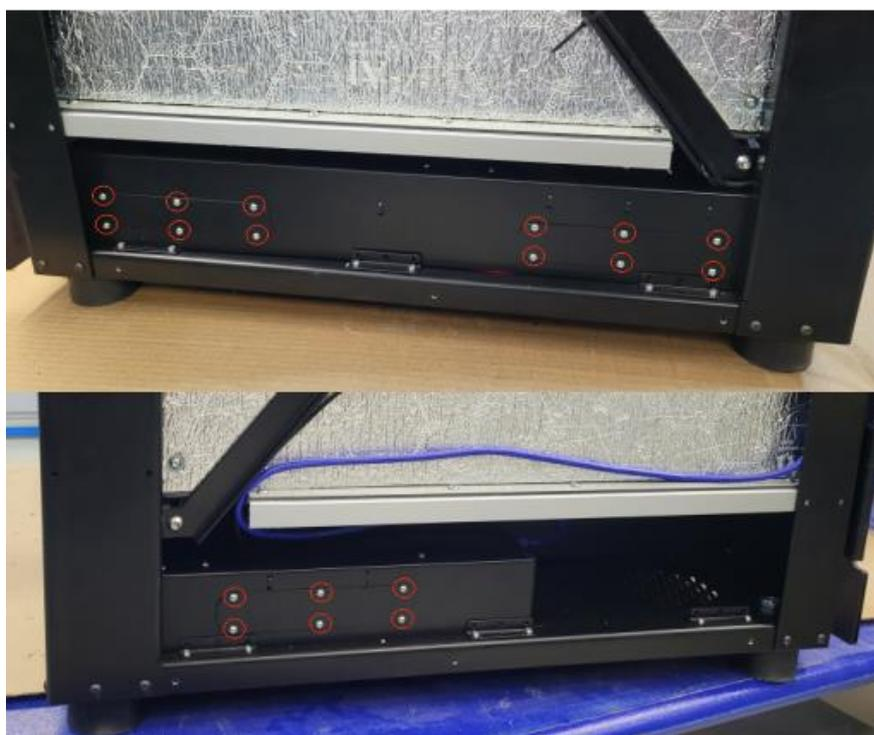
3. Через прорези очистить вентиляторы и внутреннее пространство модулей электрики и питания с помощью пылесоса, сжатый воздух не использовать:
