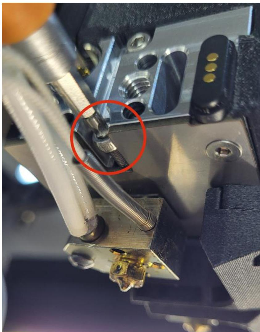
Извлечь принтблок из печатающей головки:
