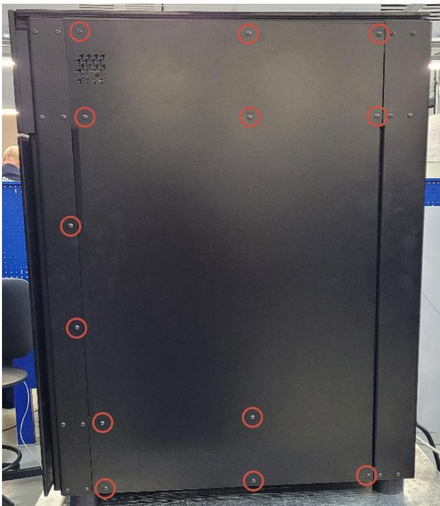
2. Прорези для очистки от пыли закрыты на левом блоке 6 винтами, а на правом блоке – 12 винтами. Следует открутить их и снять крышки.
