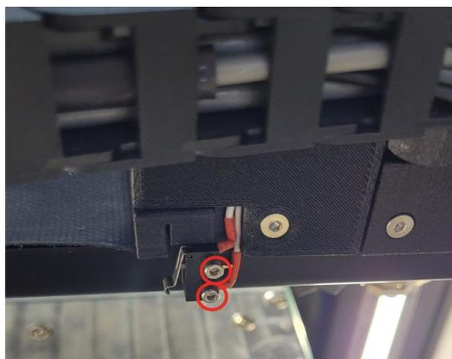
3. Снять боковые панели принтера, чтобы получить доступ к рельсам продольного перемещения портала вдоль оси Y. Для этого следует открутить по 13 винтов на каждой боковой панели и снять их:
