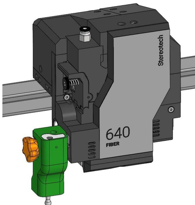
Чтобы сообщить программному обеспечению принтера о корректной работе датчика калибровки, по требованию менеджера следует нажать на зонд датчика снизу вверх. После установки датчика и получения сигнала от него начинается процесс автокалибровки платформы. После завершения процесса автокалибровки датчик следует отключить по соответствующему приглашению менеджера.
