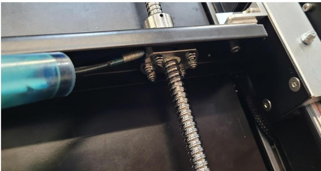
6. Для смазки цилиндрических направляющих подсоединить к тавотнице рычажно-плунжерный шприц и добавить через неё около 1,25 мл смазки:
