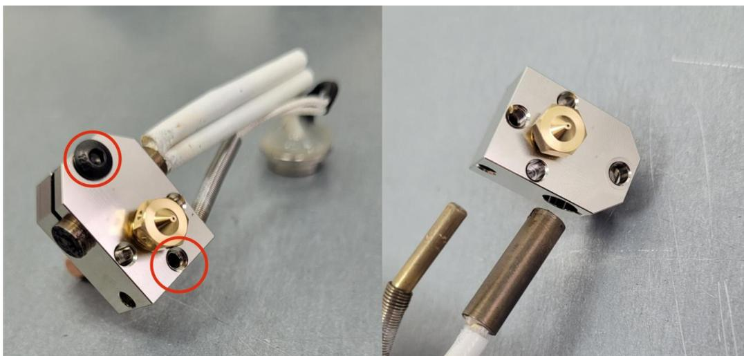
Поджимать винт датчика температуры следует с осторожностью. Винт закручивается до появления лёгкого сопротивления. При чрезмерной затяжке гильза датчика деформируется, он может выйти из строя.
