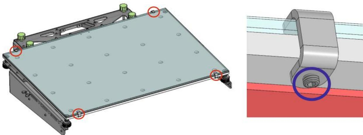
Для установки стекла следует задвинуть его в два задних зажима, установить передние зажимы и закрутить все 4 винта.
