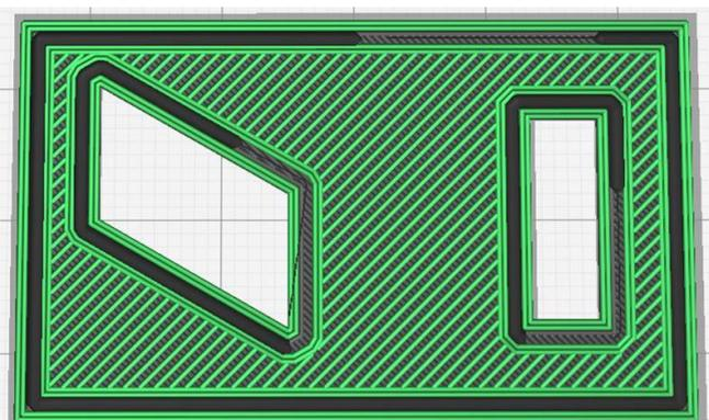
При армировании контуров следует проверить, нет ли слишком больших перегибов в армирующих траекториях. Если перегибы есть, очертания модели следует сглаживать так, как описано выше.
