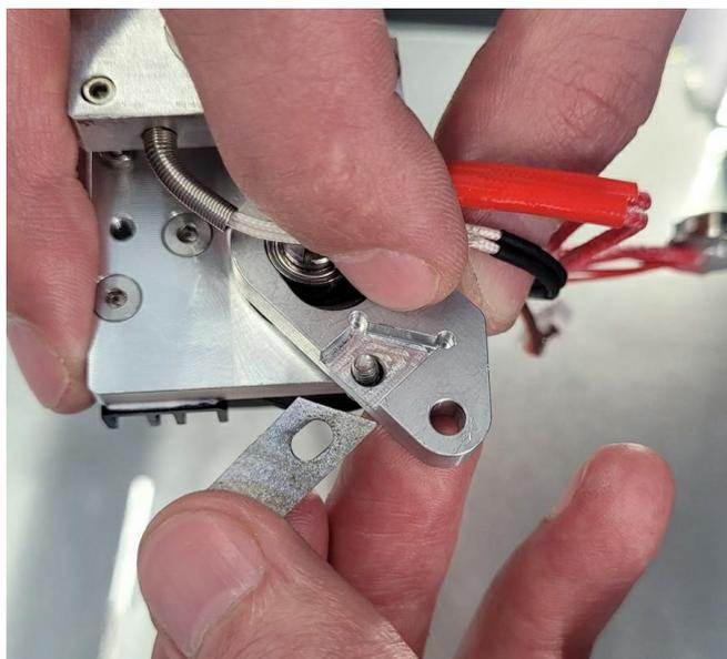
После замены лезвия повторите все действия выше в обратном порядке. Затем посмотрите на просвет в канале подачи непрерывного волокна. Лезвие не должно перекрывать канал, обрезок волокна должен свободно проходить сквозь экструдер, не цепляя за лезвие:
