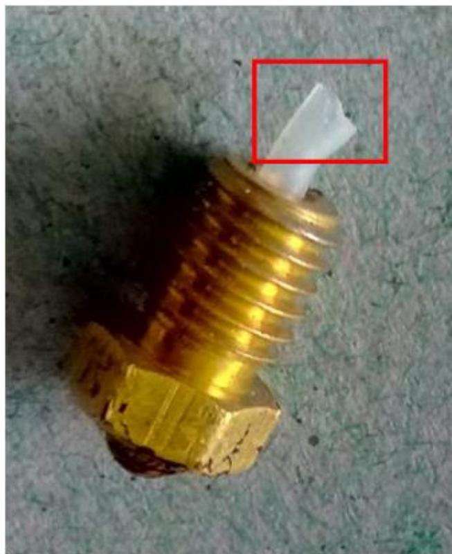
Допускается сначала пропустить фрагмент волокна через экструдер и только потом накрутить сопло, используя волокно как направляющую
