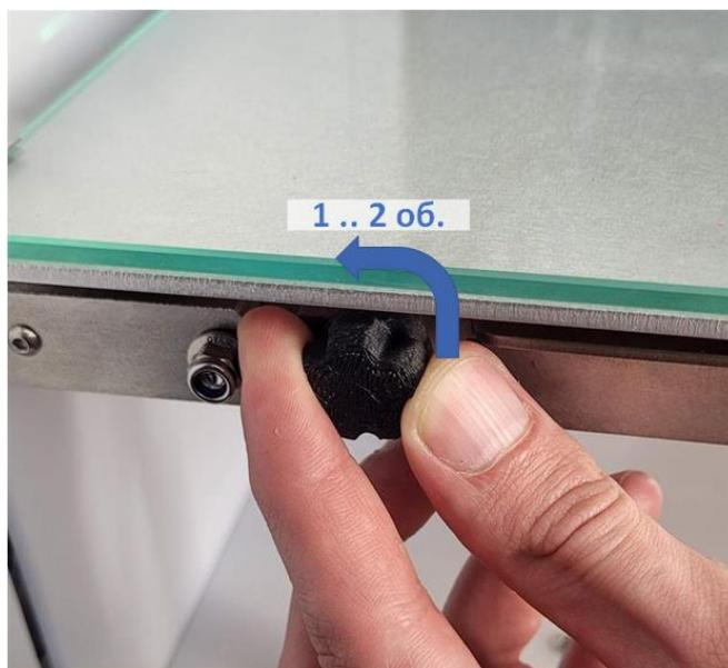
Сдвиньте модуль вперёд и вверх по пазам, как показано на фото ниже. Если на одном из держателей модуль не двигается - проверните барашек ещё на пол-оборота:
