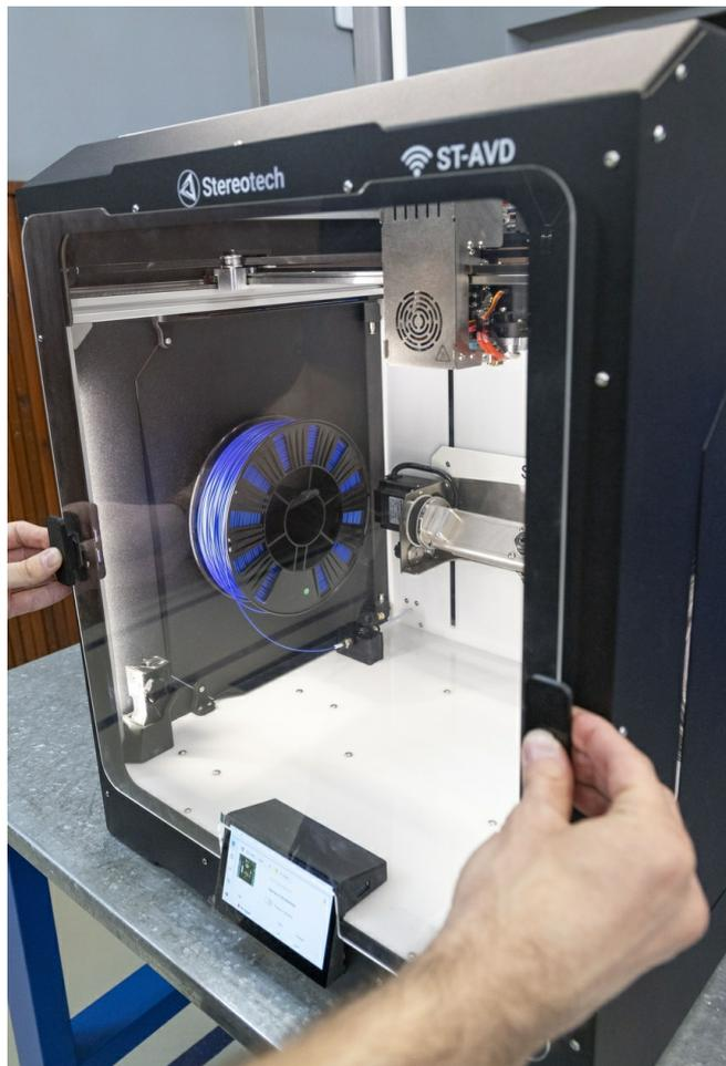
Воспользуйтесь кусачками из сумки с принадлежностями для удаления транспортировочных стяжек. Удалите две транспортировочные стяжки в передней верхней части 5D принтера на ремнях, затем удалите транспортировочную стяжку фиксации рабочей платформы.
