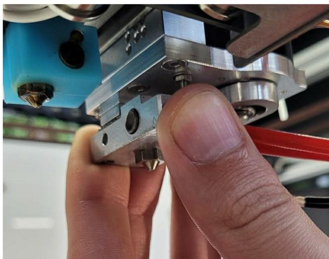
Для установки экструдера в печатающую головку действовать в обратную сторону: вставить направляющую экструдера в печатающую головку, задвинуть её до упора, закрутить регулировочный барашек, подключить жгуты нагревателя и сервопривода отсечения, поставить на место лицевую панель.
