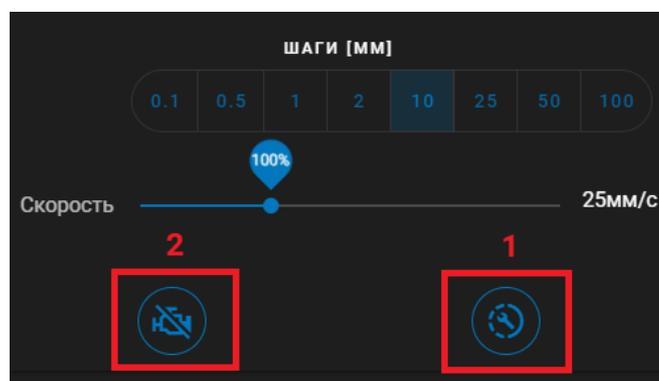
Выведите волокно из экструдера обратным движением подачи (на экране ручного управления экструдером для волокна):
