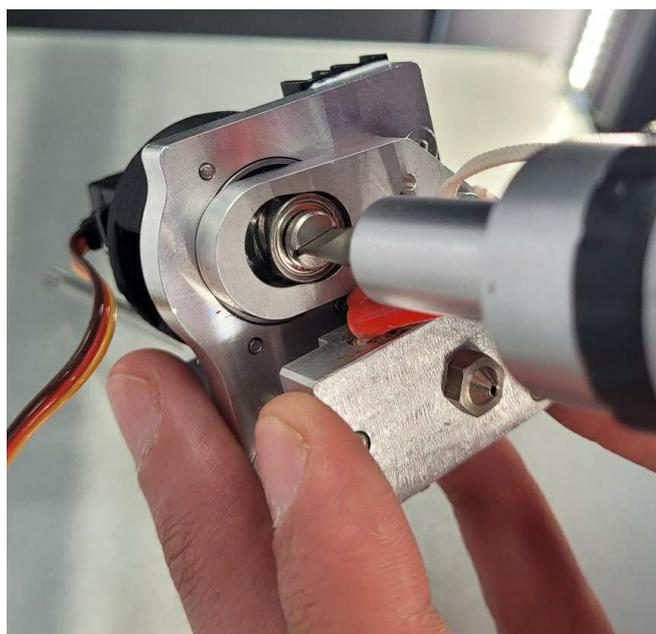
Нож должен сделать полный оборот и отрезать волокно, после этого канал должен быть свободным, волокно должно свободно проходить сквозь экструдер. Если лезвие не отрезает волокно, следует ослабить крепление лезвия и немного подвинуть его вперёд (от задней части
