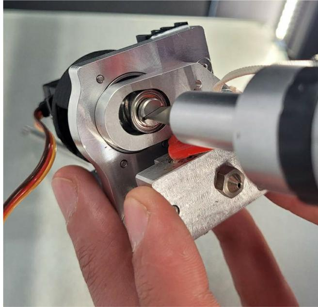
Ослабьте два винта, фиксирующих жгут нагревателя и датчика температуры, согласно фото ниже:
