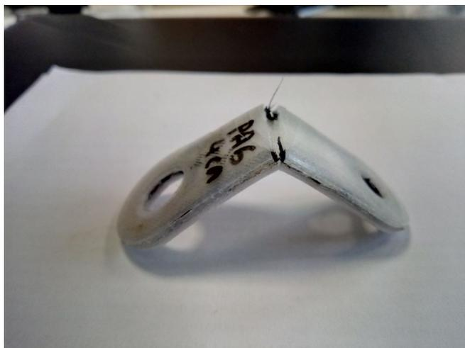
Как аналог PA6 для печати с армированием можно использовать пластик [ABS/PA6](#) - он менее гибкий и износостойкий, но проще в работе и не так склонен к набору влаги. Для печати высокопрочных армированных деталей для больших нагрузок рекомендуются композиционные материалы на основе PA6, наполненные короткими волокнами (серия Fiberpart) [PA6 C30](#), [PA6 G30](#), [ABS/PA6 G8](#).
