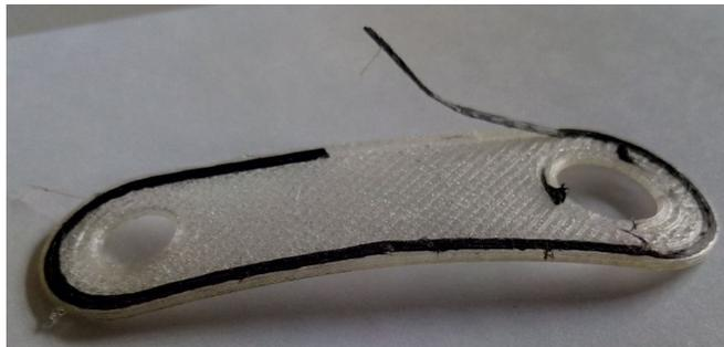
В этом случае необходимо установить сопло для волокна ниже. Настройте высоту экструдера заново с щупом 0,15 мм либо поверните регулировочный барашек *на 1-2 деления* против часовой стрелки (если нужно отрегулировать высоту в процессе печати).
