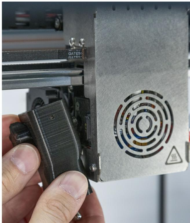
По требованию менеджера нажмите на зонд датчика снизу вверх. Это необходимо для того, чтобы сообщить программному обеспечению принтера о корректной работе датчика калибровки. После установки датчика и получения сигнала от него начинается процесс автокалибровки.
