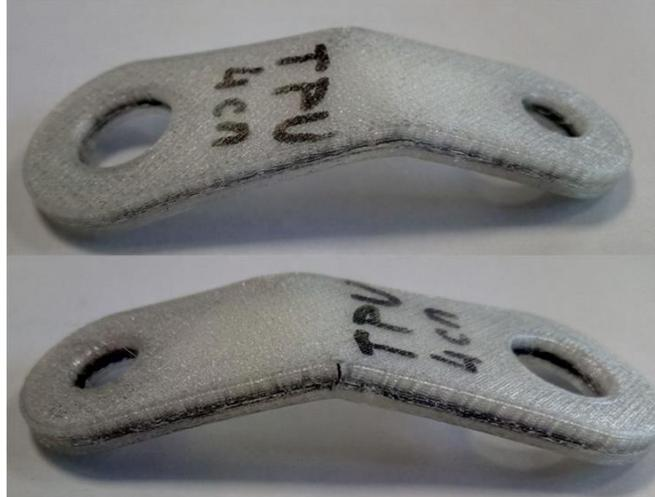
Для более нагруженных деталей рекомендуется использовать материалы на основе TPU из серии Fiberpart [TPU C5](#), TPU G10, [TPU G30](#).
