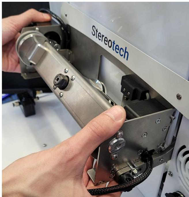
Наживите с помощью барашков конусные винты слева и справа (примерно на 1 оборот) таким образом, чтобы модуль нельзя было сдвинуть вперед-назад. Затяните до упора фиксирующие гайки с помощью ключа, затем слегка подтяните конусные винты.
