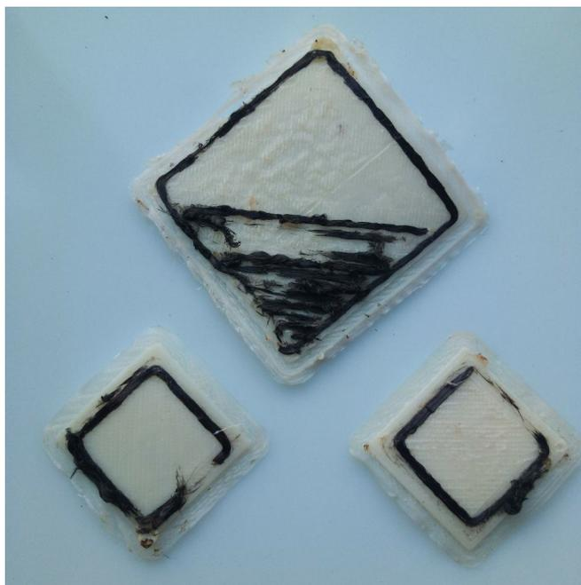
В этом случае необходимо установить сопло для волокна выше. Настройте высоту экструдера заново с щупом **0,25 мм** либо поверните регулировочный барашек *на 1-2 деления по часовой стрелке* (если нужно отрегулировать высоту в процессе печати).
