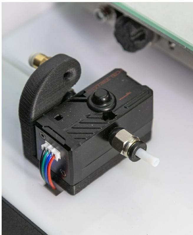
При остановке прутка принтер автоматически перейдёт в режим паузы и уведомит об ошибке. После решения возникшей проблемы можно снять принтер с паузы и продолжить печать. Датчик можно включить или выключить в меню "Настройки" - "Контроль материала".
