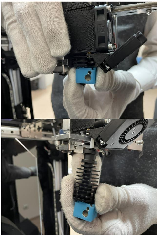
Принтблок устанавливается в радиатор до упора и поджимается двумя винтами по боковой поверхности. Их нужно ослабить другим комплектным ключом и заменить принтблок.
