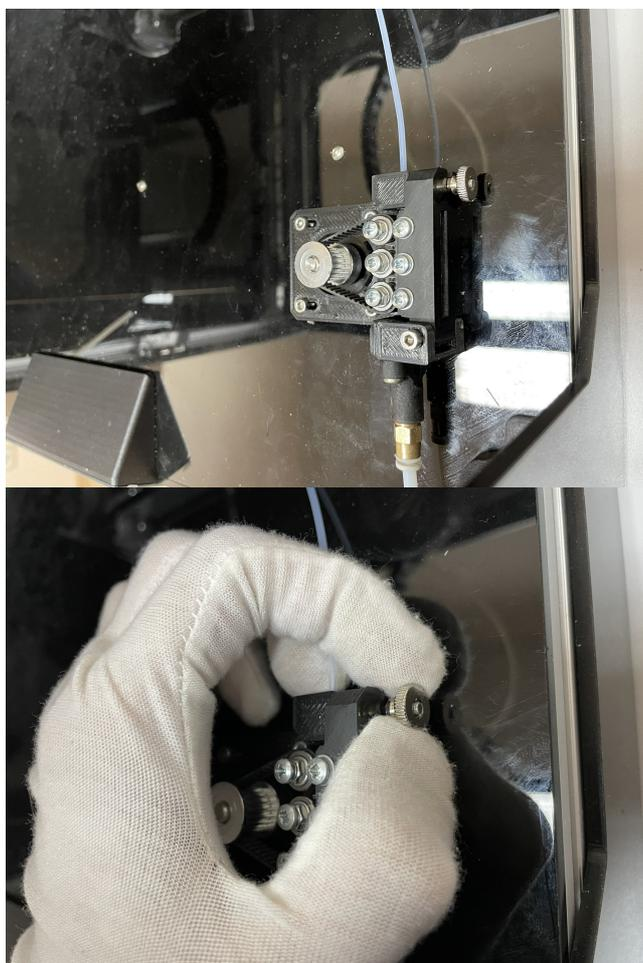
Затем протолкните волокно вдоль подающего ремня через небольшие отверстия в рамке подающего узла, как показано на изображении ниже
