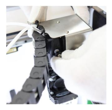
Через каждые пол-оборота винта пробуйте подавать материал через сопло. Достаточный прижим обеспечен, если материал подаётся равномерно, нить на выходе - ровная и соответствует по диаметру соплу установленного принтблока (по умолчанию устанавливается сопло с диаметром 0,4 мм). Регулировка прижима вспомогательного (правого) экструдера регулируется аналогично. Для него двигатель подачи и регулирующий винт находятся на дне рабочей камеры, у правой дверцы принтера:
